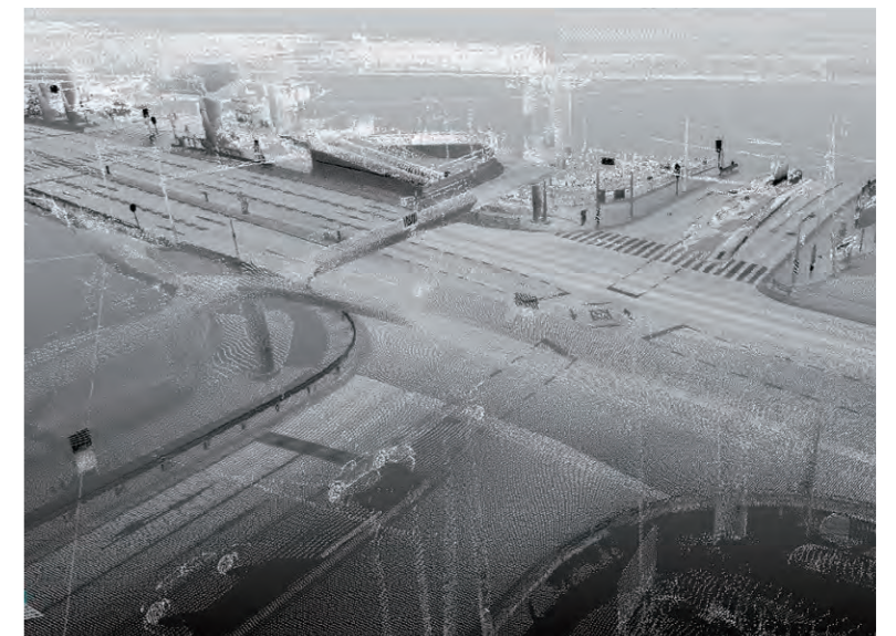
MMS（モービルマッピングシステム）計測による3次元点群データ
