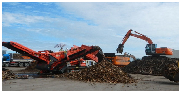
写真1 木くずの破碎・選別処理工程
