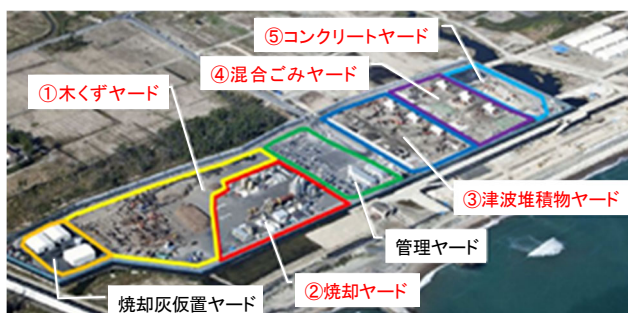
図2 二次仮置場の施設配置
