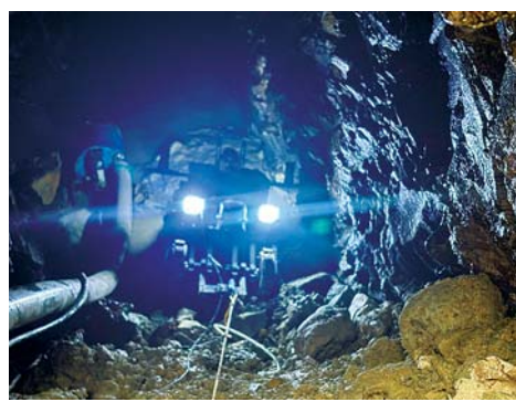
ライトを搭載したエイト日本技術開発のクローラー型ロボット
