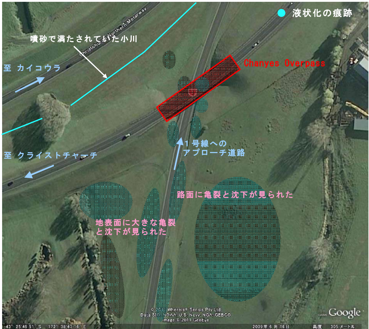
図-7.3.2 Chanyes Overpass 周辺の液状化発生痕跡（現地での目視範囲）
