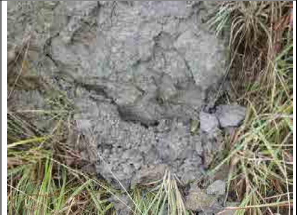
写真-6.3.14 斜面を構成するシルト岩。鱗片状に割れており海成層と思われる。
