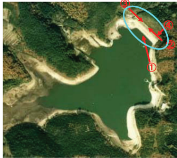
③ ダム軸左岸側から右岸望む 右岸側の堤防は堤長の1/3が全て流出 する。最初の破堤箇所・湖水の集水箇所
