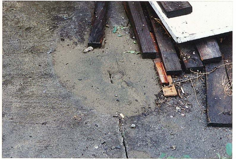
写真-2 (上) ミッション地区における噴砂 —— ミッション、サウスマーケット地区では この程度の噴砂が多く見られた。
