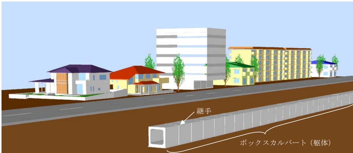
図 1.1 暗渠構造物（ボックスカルバート）
