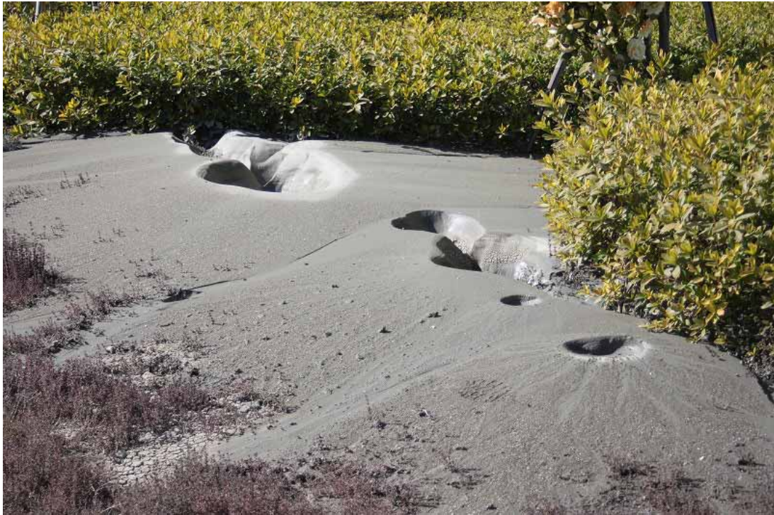
海浜幕張駅前（北側）の噴砂、沈下。左は駅に接した建物、右は駅正面の建物。
