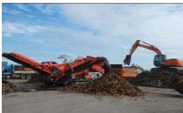
写真1 木くずの破碎・選別状況
