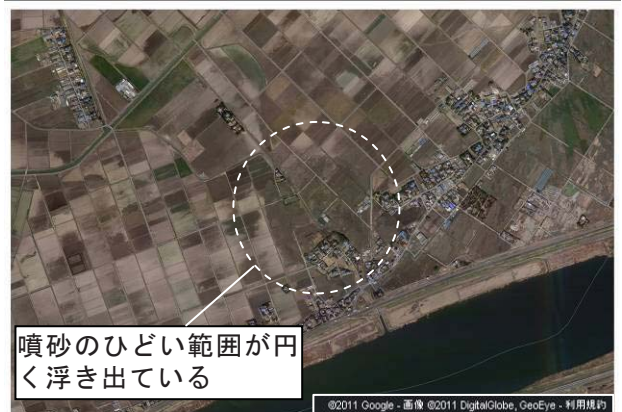
写真3 六角地区の噴砂発生状況 2)
