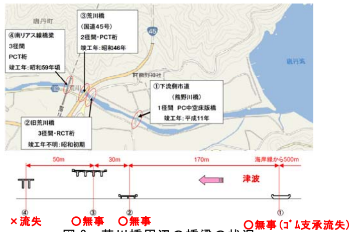
図3 荒川橋周辺の橋梁の状況
