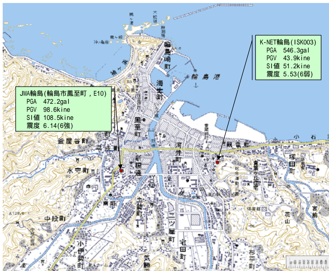
図3.1 輪島市中心部の強震観測点
